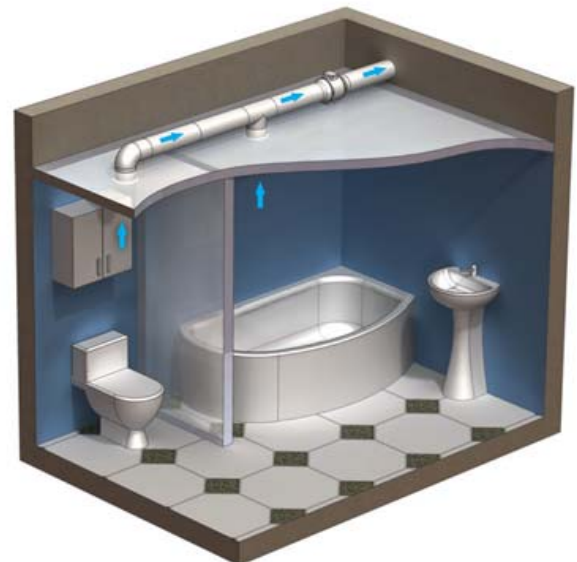
Bad- / WC Entlüftung
