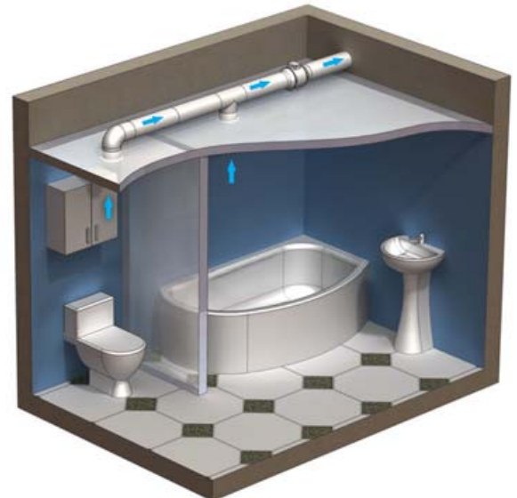
Bad- / WC Entlüftung
